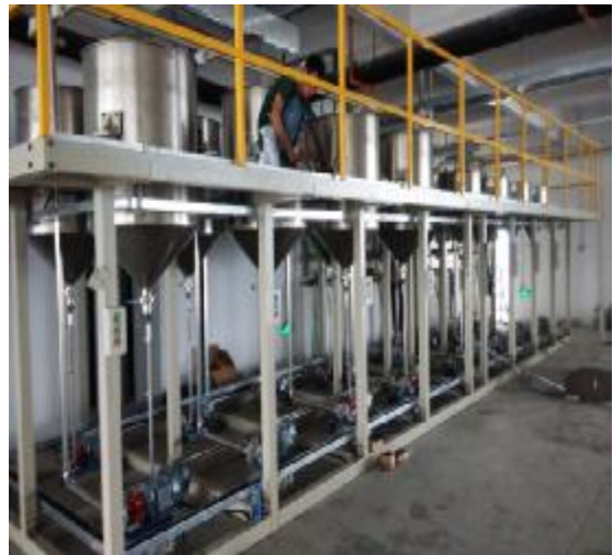
配料系统：采用托利多传感器，精度千分之三，西门子 S7-300 PLC
