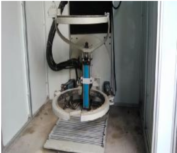
非标液压机构：用于搬运倾倒油桶，采用液压控制
